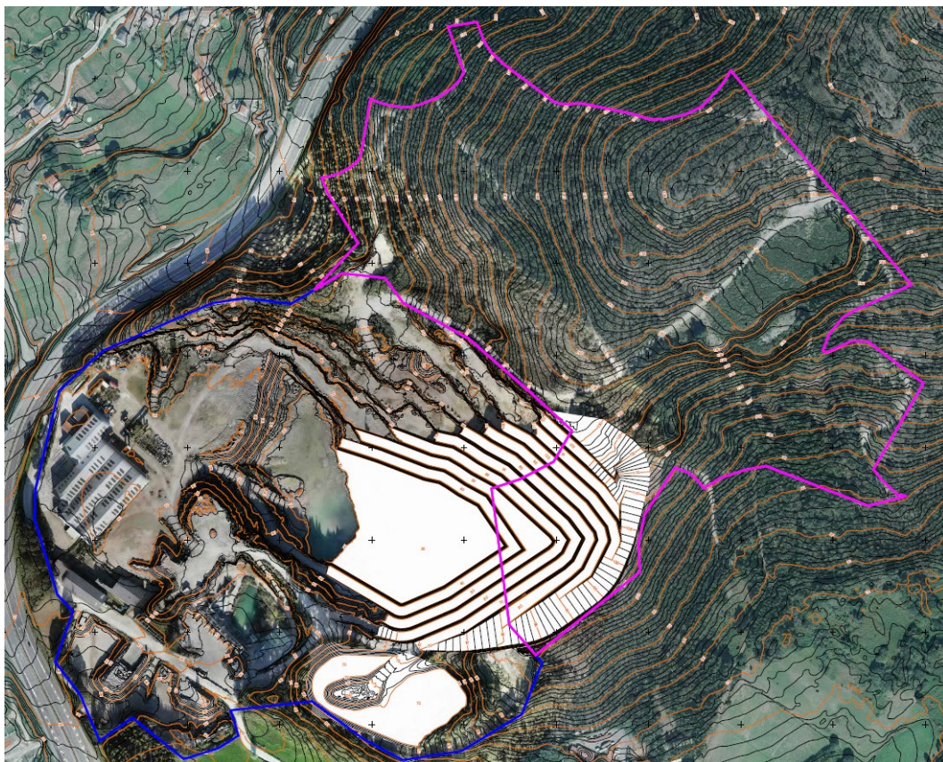
IMAGEN 6.5: PLANTA TOPOGRÁFICA AL TÉRMINO DE LA SITUACIÓN INTERMEDIA FASE 1. FUENTE: ESMIN INGENIERÍA
