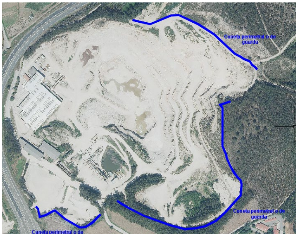
IMAGEN 2-2: SITUACIÓN ACTUAL DE LA SCUNETAS PERIMETRALES O DE GUARDA.
