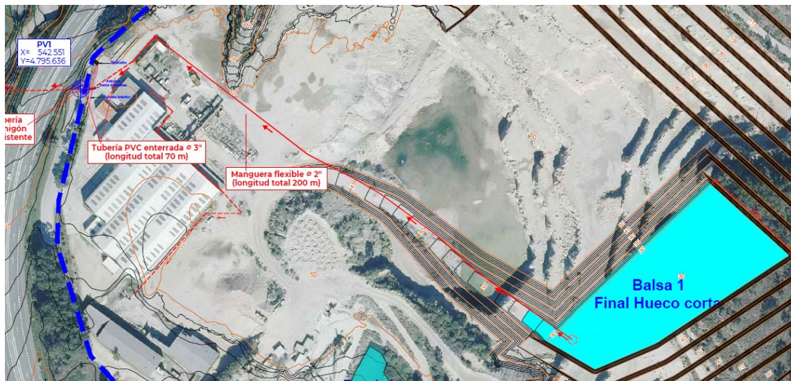
IMAGEN 3-27: RECORRIDO DEL AGUA DESDE EL HUECO HASTA EL PUNTO DE VERTIDO
