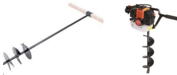
ILUSTRACIÓN 6.1: IMÁGENES DE AHOYADORES MANUAL Y MECÁNICO
